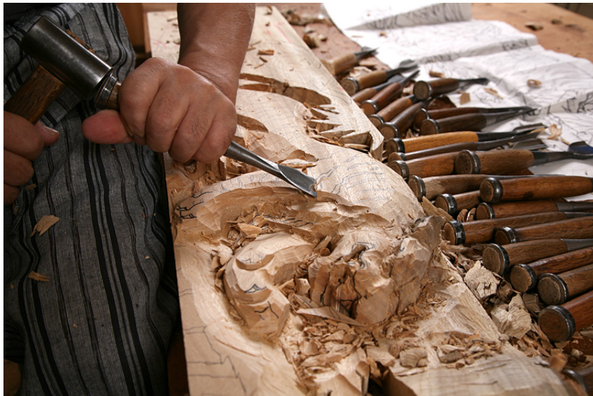
図 1.3: 素材である木材に粗彫りを施している様子
