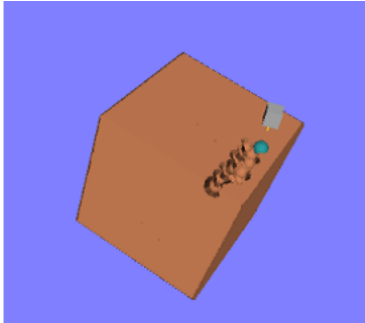
図 2.4: 素材モデルに切削処理を行う様子
